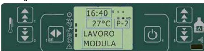
fig. 27 painel de comandos - modular a temperatura definida
