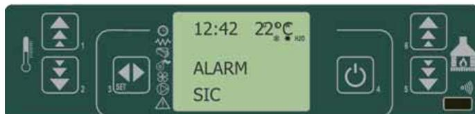
fig. 38 painel de comandos - alarme por termóstato geral
