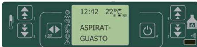
fig. 39 painel de comandos - alarme ventilador de aspiração de fumos
