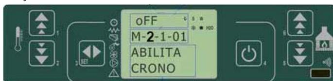
fig. 17 painel de comandos - habilitação das funções do cronotermóstato
