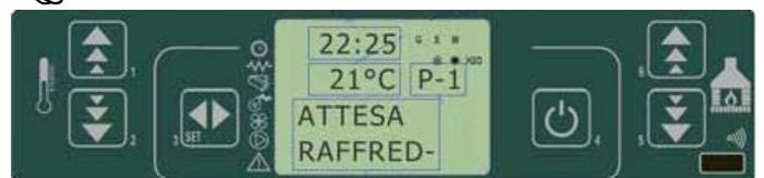
fig. 31 painel de comandos - aguardar arrefecimento antes de reacender
