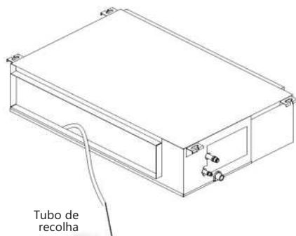
Encha a bacia de água com 2 litros de água. Verifique se o tubo de drenagem se encontra desimpedido.
