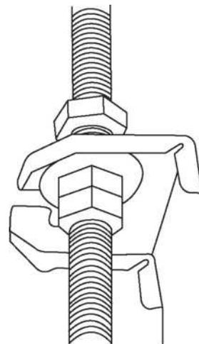
9. Monte a unidade interior nos parafusos de fixação com um bloco. Posicione a unidade interior a um nível plano utilizando um indicador nivelador para evitar fugas.
