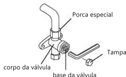
12. Usando uma chave hexagonal, abra totalmente as válvulas de pressão alta e de pressão baixa.
