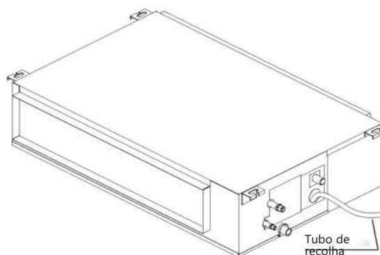
2. Ligue a unidade no modo de ARREFECIMENTO. Ouvirá a bomba de drenagem. Verifique se a água está a ser descarregada adequadamente (é permitido um atraso de 1 minuto, dependendo do comprimento do tubo de drenagem), verifique se há fugas de água das juntas.
