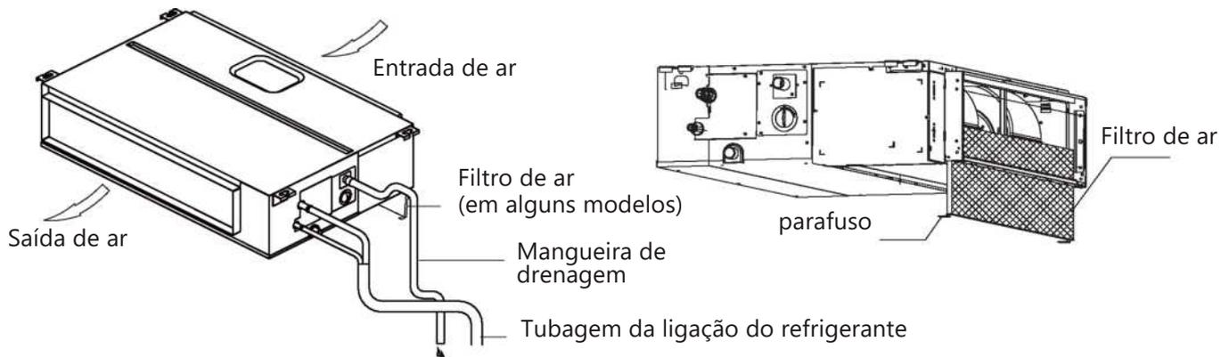
1. Coloque o filtro no subconjunto do flange através do lado inferior;
