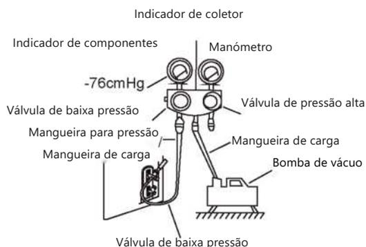
6. Feche o lado de baixa pressão do indicador do coletor e desligue a bombas de vácuo.
