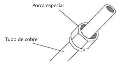
4. Retire a fita de PVC das extremidades do tubo quando estiver pronto para realizar o trabalho de abocardagem.
