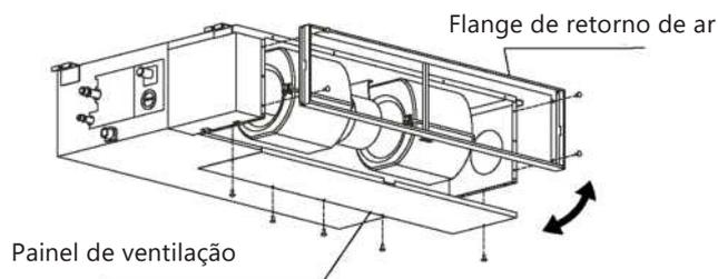
Dobre o painel de ventilação traseiro 90 graus ao longo da linha pontilhada num painel de ventilação descendente. (alguns modelos)
