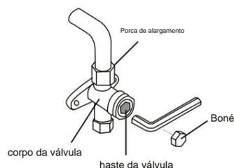
12. Utilizando uma chave hexagonal, abra totalmente as válvulas de alta e baixa pressão.
