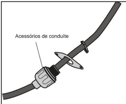
3. Passe o cabo pelo orifício do arame, da parte traseira da unidade para a frente.
