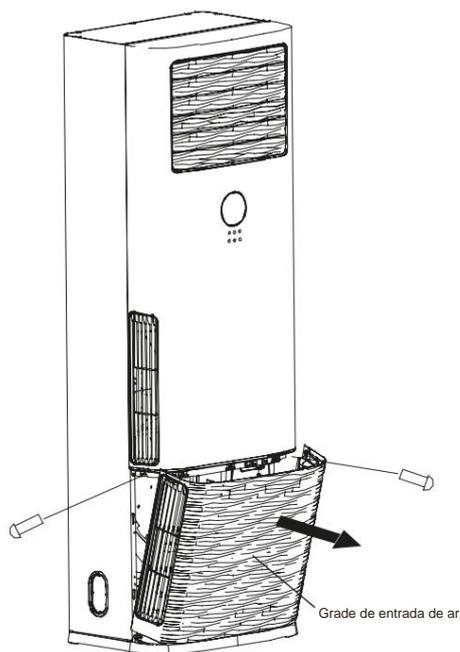
7. Remova todos os acessórios colocados dentro da cavidade inferior da unidade interna.
