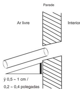
3. Coloque o cu da parede protetora no orifício. Isso protege as bordas do furo e ajudará a selá-lo quando você terminar o processo de instalação.
