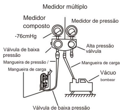
6. Feche o lado de baixa pressão do manômetro e desligue a bomba de vácuo.
