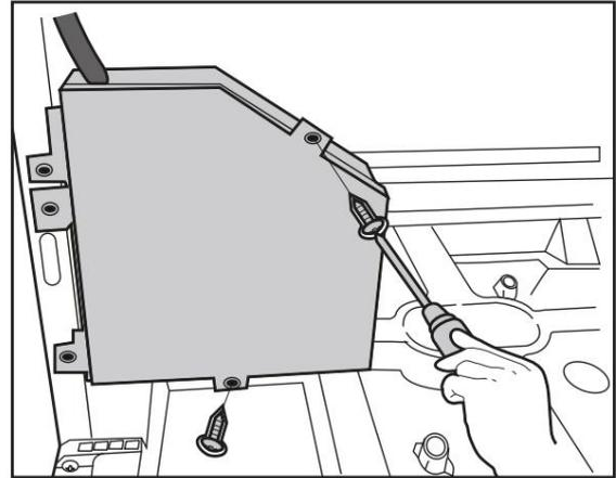
5. Aperte os parafusos para fixar o conduíte configurações na parte traseira da unidade.
