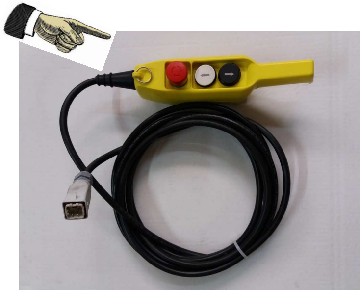
Botão “Paragem de emergência” no comando de controlo.
